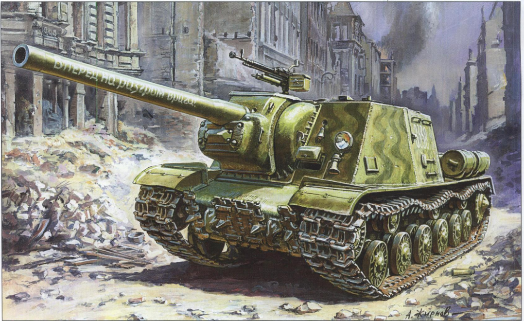
Самоходная установка ИСУ-122 с пушкой калибра 122 мм была выполнена на базе танка ИС-2. Аналогичная ИСУ-152 оснащалась более мощной гаубицей-пушкой калибра 152 мм. На последней странице обложки изображен самый мощный советский танк периода Великой Отечественной войны ИС-2. Он был вооружен пушкой калибра 122 мм.
